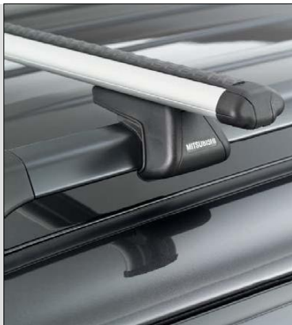
MZ314635 Дуги багажника поперечные, с замком (для а/м с рейлингами) Максимальная нагрузка - 80 кг.
